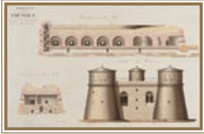
Zeichnung des Fort Thüngen. Ansicht des Eingangs sowie Längs- und Querschnitt
