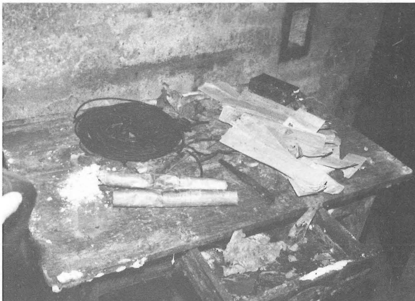
Fig. I Cartouche de luxite (explosif), mèche lente, papier de bourrage.
