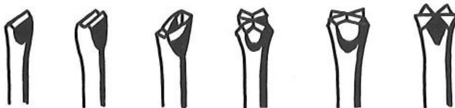
Bohrerschneiden für schlagendes Bohren
